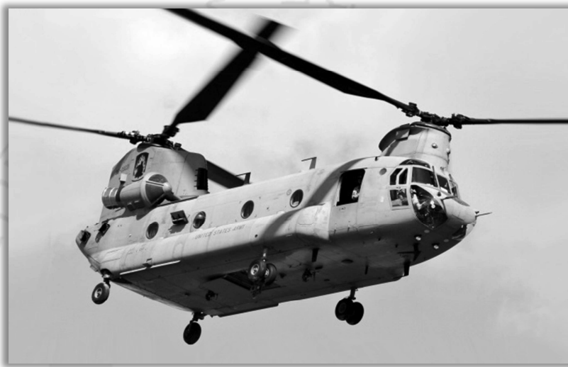
ตัวอย่างรูปภาพ เฮลิคอปเตอร์ลำเลียงหนัก Boeing CH-47F Chinook (Wikipedia)
