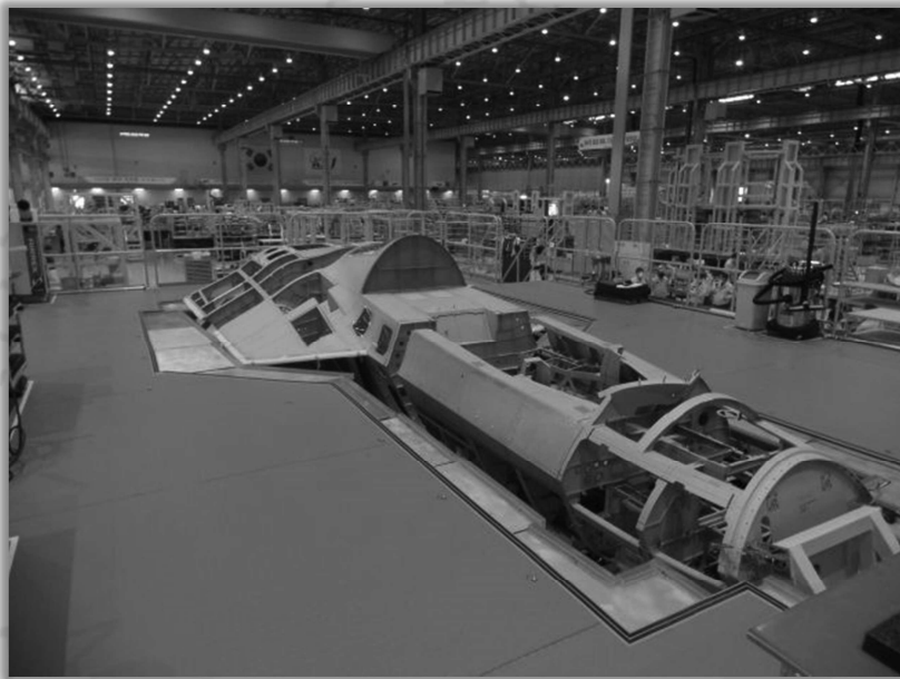
รูปภาพ โครงลำตัวเครื่องบิน KF-X เครื่องต้นแบบ (KAI)
