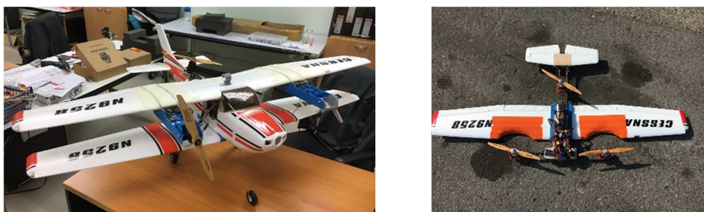
ภาพที่ 3. ต้นแบบ VTOL Tilt Rotor ที่ผ่านมา ซึ่งทำการบินไม่สำเร็จ
