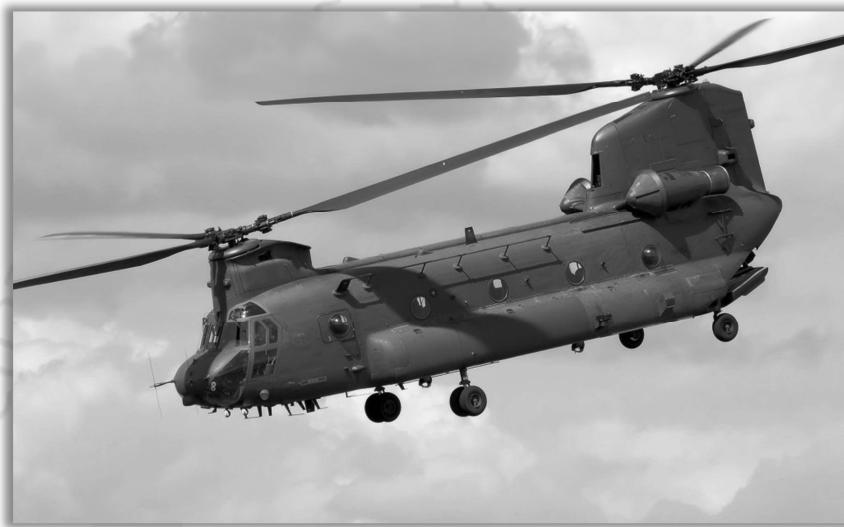
ตัวอย่างรูปภาพ เฮลิคอปเตอร์ลำเลียงขนาดหนัก CH-47 Chinook (Wikipedia)
