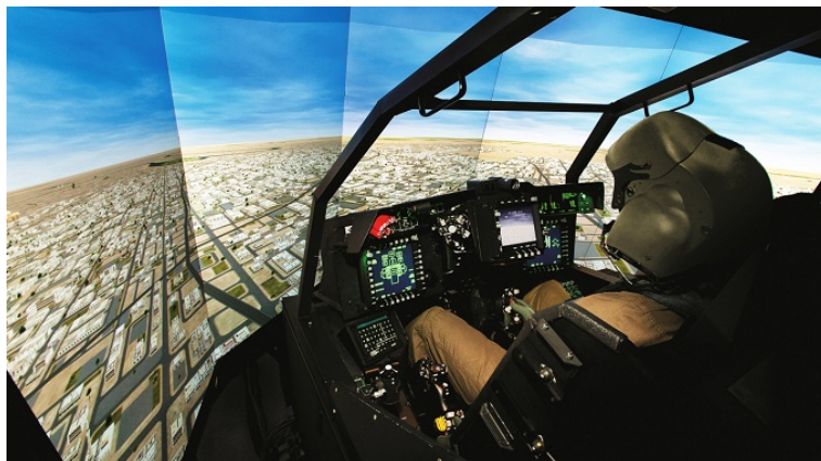
รูปที่ 4 เครื่องช่วยฝึกเสมือนจริงการบินอากาศยานปีกหมุน
