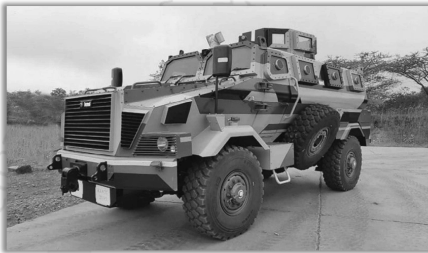
ตัวอย่างรูปภาพ รถเกราะล้อยาง Gaur แบบ 4X4 (CCTV 7 via js7tv.cn)
