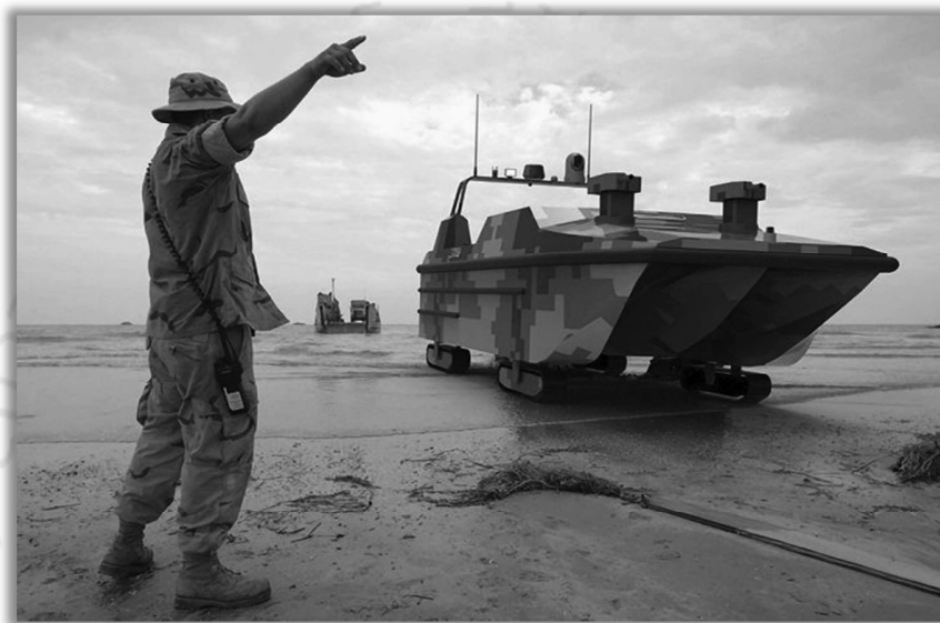
รูปภาพ Marine Lizard Amphibious Combat Unmanned Surface Vessel : USV (CSIC)
