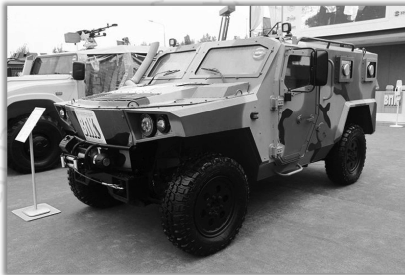
ตัวอย่างรูปภาพ รถเกราะสะเทินน้ำสะเทินบกขนาดเบาแบบ 4x4 Strela (Nikolai Novichkov)
