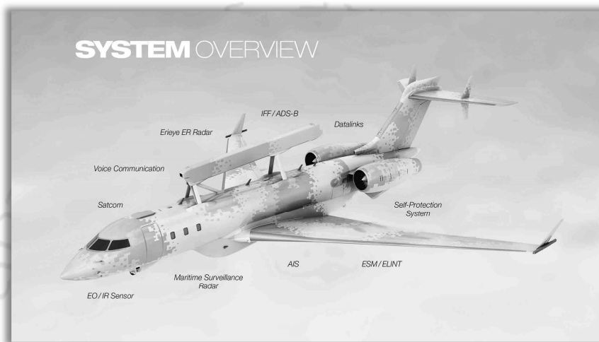
ตัวอย่างรูปภาพ ภาพรวมของระบบ GlobalEye AEW&C (Saab)
