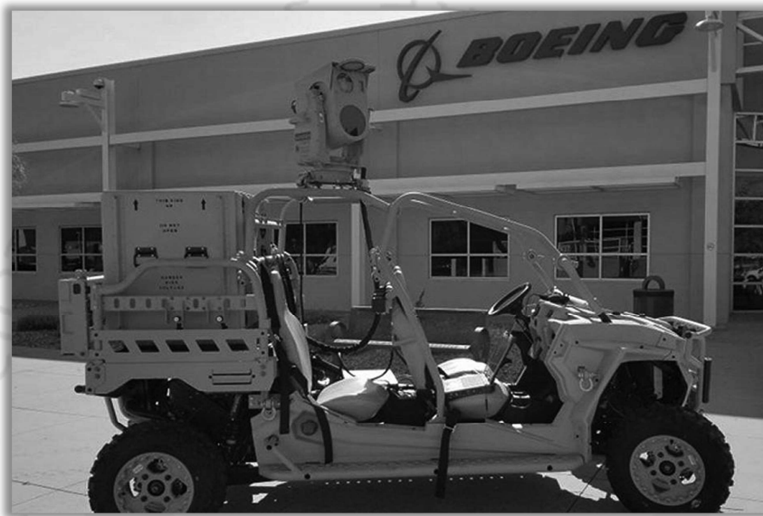
ตัวอย่างรูปภาพ อาวุธเลเซอร์ CLWS ติดตั้งบนยานพาหนะอเนกประสงค์ขนาดเล็ก (Boeing)
