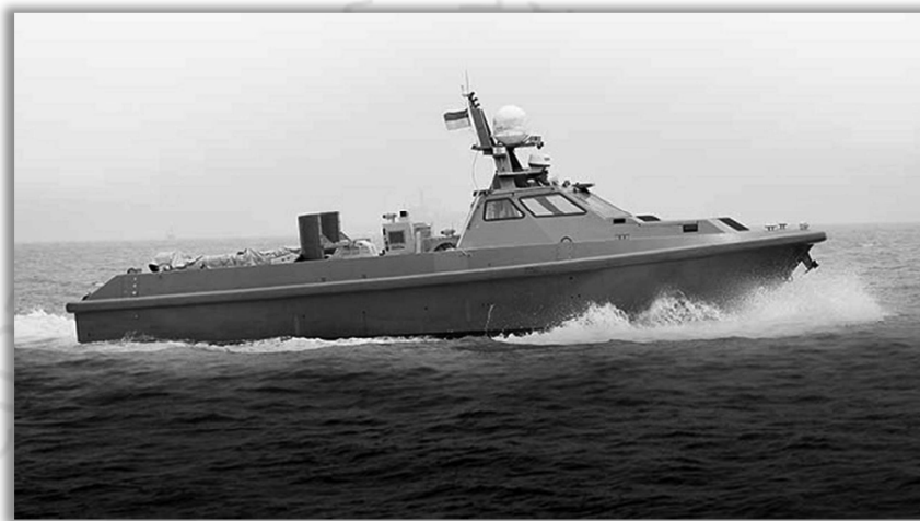
รูปภาพ เรือผิวน้ำไร้คนขับสำหรับป้องกันชายฝั่ง (RSN)
