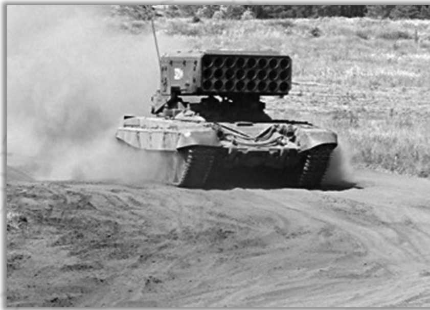
ตัวอย่างรูปภาพ ระบบจรวดหลายลำกล้อง TOS-1A (Russian MoD)
