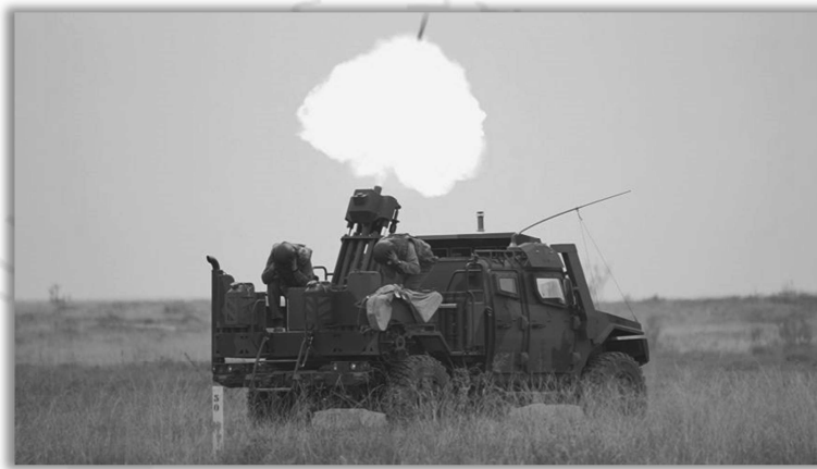
รูปภาพ การแสดงการยิงของเครื่องยิงลูกระเบิดอัตโนมัติ Dual-ELMOS (EXPAL)
