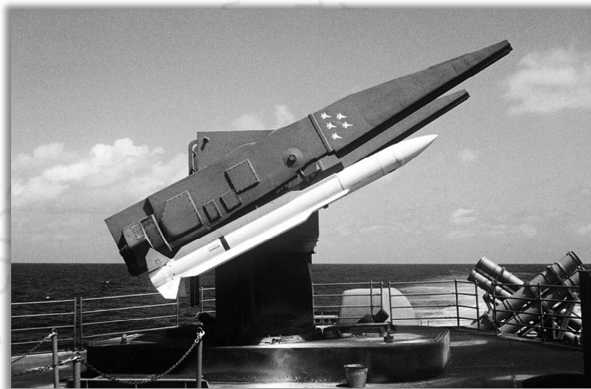
ตัวอย่างรูปภาพ จรวด SM-2 บนแท่นยิงจรวด Mk-26 (Wikipedia)
