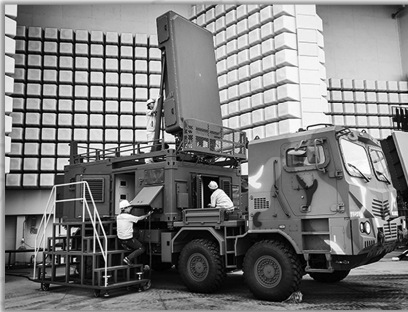
ตัวอย่างรูปภาพ ระบบเรดาร์ต่อต้านปืนใหญ่ (LIG Nex1)
