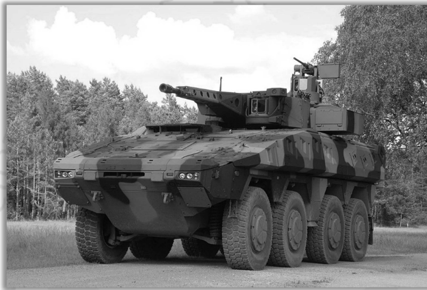
ตัวอย่างรูปภาพ ยานเกราะล้อยาง Boxer (Wikipedia)
