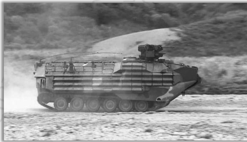
ตัวอย่างรูปภาพ ยานเกราะสะเทินน้ำสะเทินบก KAAV7A1 (Hanwha Defense)
