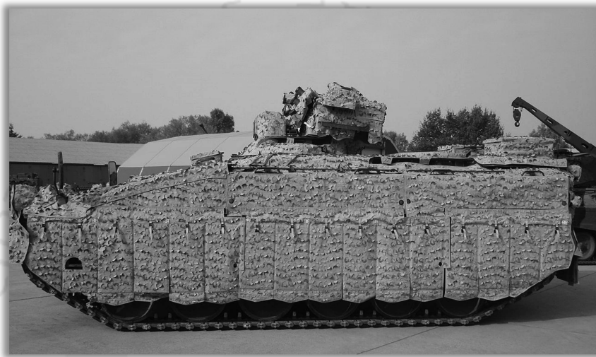
ตัวอย่างรูปภาพ ชุดพรางตัวแบบเคลื่อนย้ายได้ MCS ของบริษัท Saab (Wikipedia)
