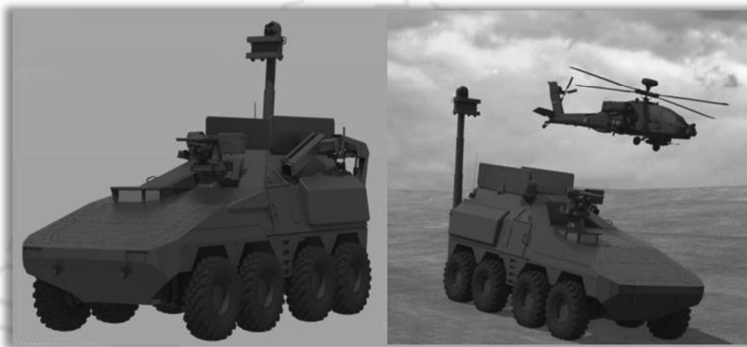
รูปภาพแบบร่าง บริษัท Lockheed Martin ออกแบบท่อยิงแนวตั้ง (VLS) สำหรับยานเกราะ Boxer (ที่มาของภาพ: Lockheed Martin UK)
