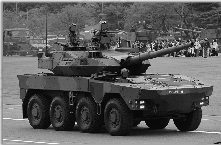
ตัวอย่างรูปภาพ ยานเกราะล้ออย่าง Type 16 (ที่มาของภาพ: Wikipedia)
