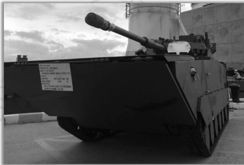
รูปภาพ ยานเกราะโจมตีสะเทินน้ำสะเทินบก VN-16 (ที่มาของภาพ: Matchon)
