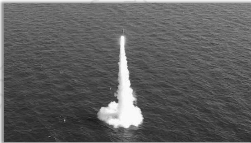
รูปภาพ การยิงทดสอบขีปนาวุธ SLBM จากเรือดำน้ำของเกาหลีใต้ (ที่มาของภาพ : ADD)
