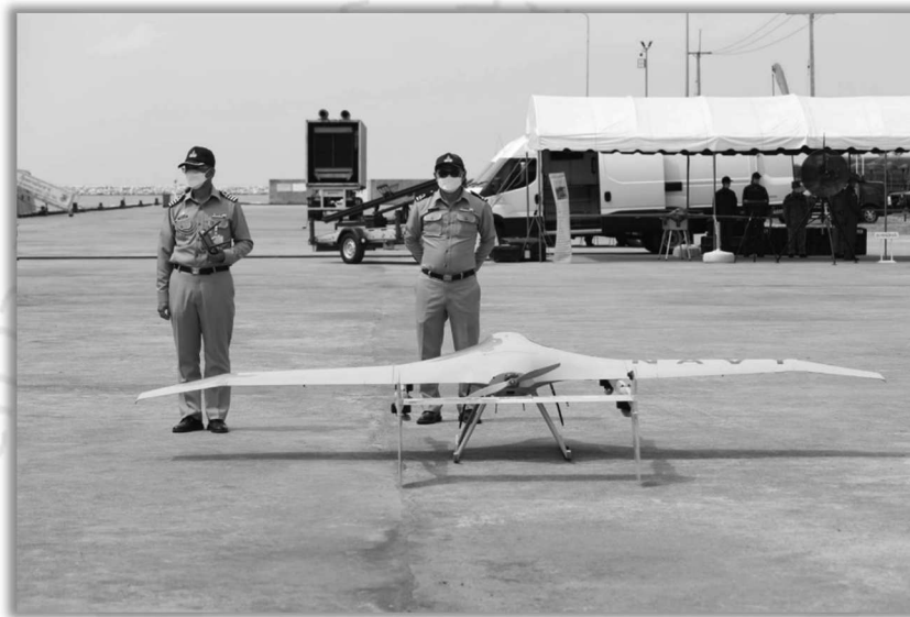
รูปภาพ อากาศยานไร้คนขับขึ้นลงทางดิ่ง MARCUS-B (ที่มาของภาพ : NRDO กองทัพอากาศไทย)
