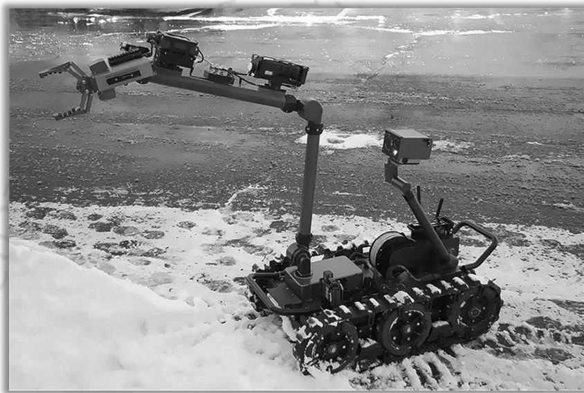
ตัวอย่างรูปภาพ หุ่นยนต์เก็บกู้วัตถุระเบิด Centaur (FLIR)
