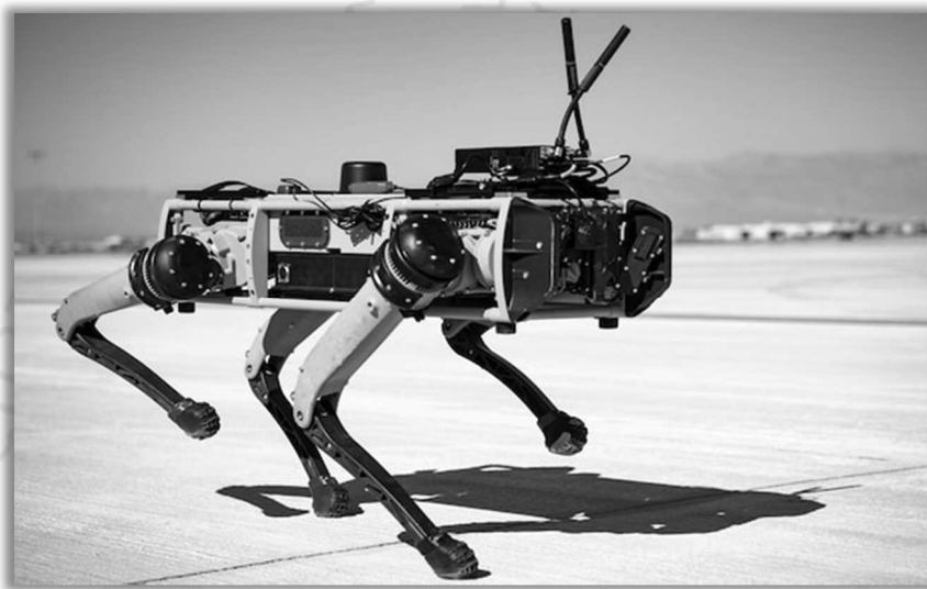
รูปภาพ ยานภาคพื้นไร้คนขับแบบสี่ขา (Q-UGV) V60 (ที่มาของภาพ : Ghost Robotics)
