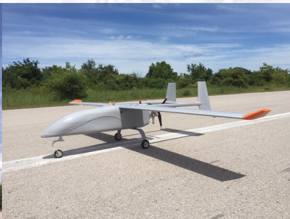
ภาพที่ 7 อากาศยานไร้คนขับแบบ Tiger Shark
