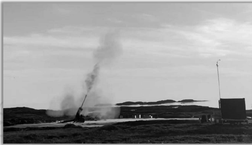
รูปภาพ การยิงทดสอบลูกกระสุนปืนใหญ่ Ramjet 155 Artillery Weapon (ที่มาของภาพ : Nammo)
