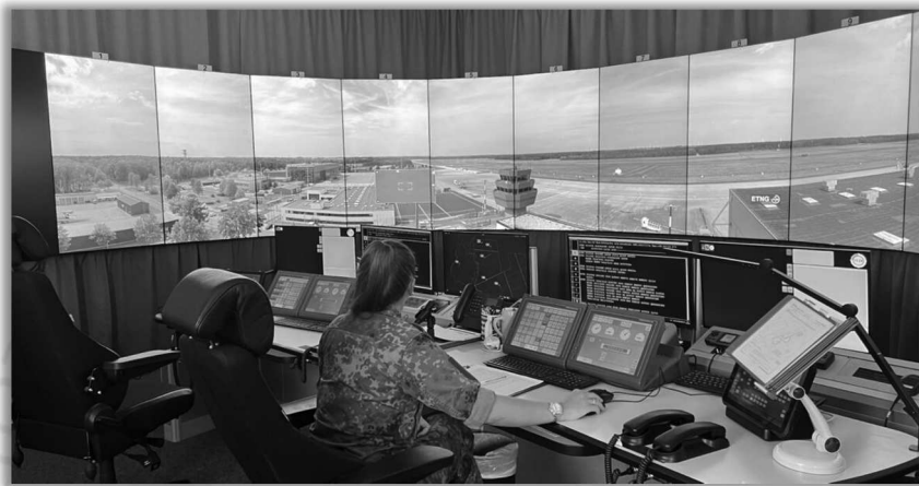
รูปภาพ หอควบคุมการจราจรทางอากาศระยะไกล (r-TWR) (ที่มาของภาพ : Saab)
