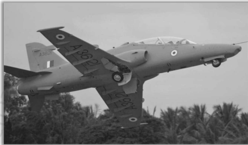
รูปภาพ เครื่องบินฝึก Hawk Mk132 (ที่มาของภาพ : HAL)
