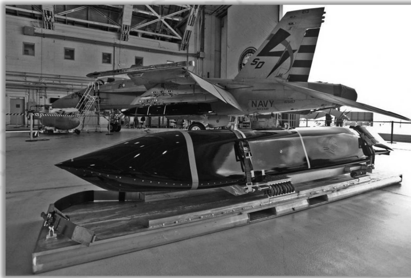
ตัวอย่างรูปภาพ จรวดต่อต้านเรือพิสัยไกล LRASM (UPI)
