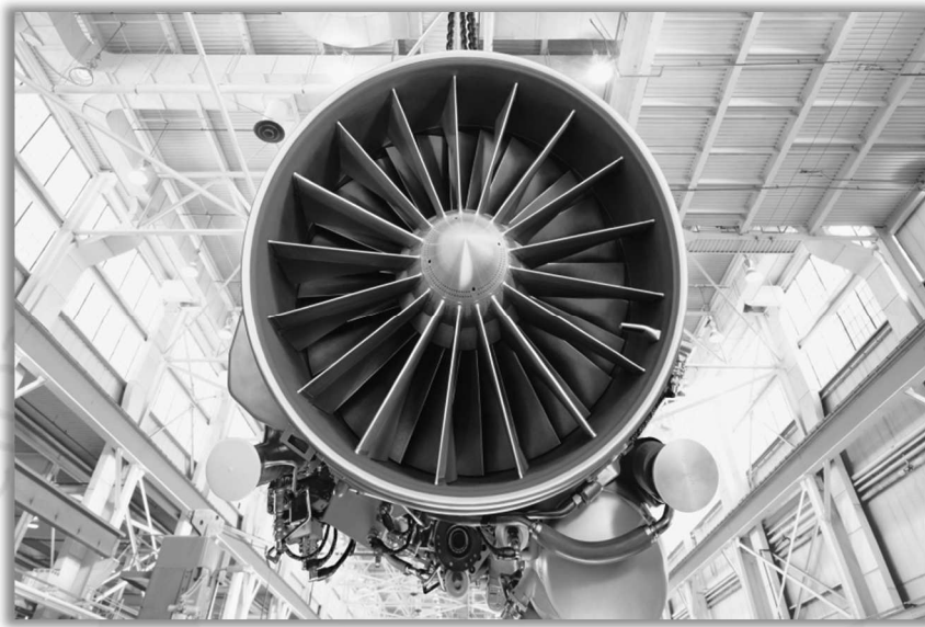
รูปภาพ เครื่องยนต์อากาศยาน F414-INS6 ของบริษัท General Electric สหรัฐอเมริกา (ที่มาของภาพ : General Electric)
