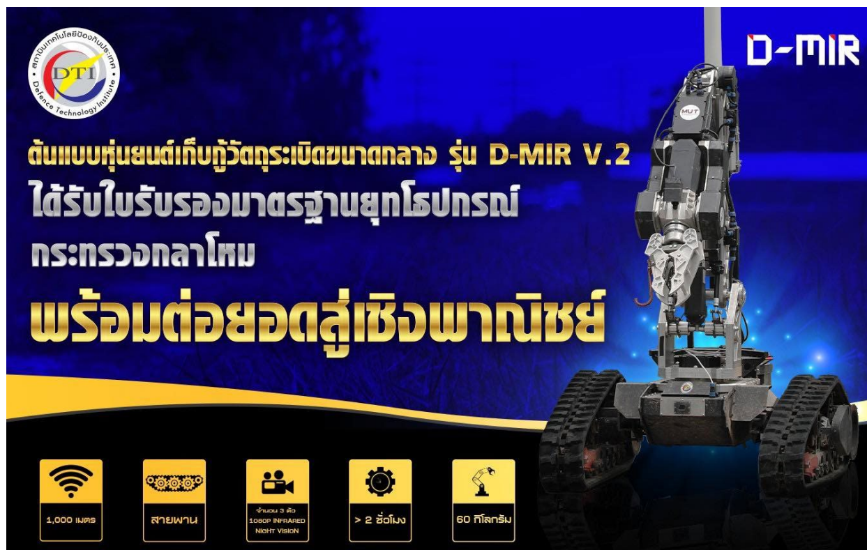
รูปภาพที่ 3 : หุ่นยนต์เก็บกู้วัตถุระเบิดขนาดกลาง รุ่น D-MIR V.2
