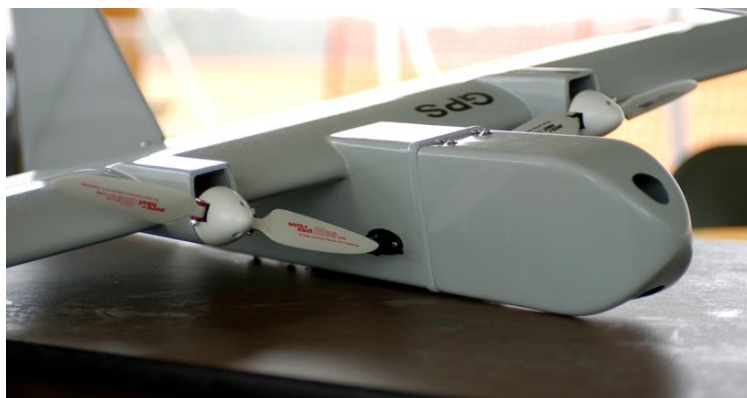
รูปที่ 2 ตัวอย่างอากาศยานไร้คนขับถ่ายภาพทางอากาศของสหรัฐอเมริกาที่ใช้เซลล์เชื้อเพลิงเป็นแหล่งพลังงาน (ที่มาของรูป : Sustainable Skies)
