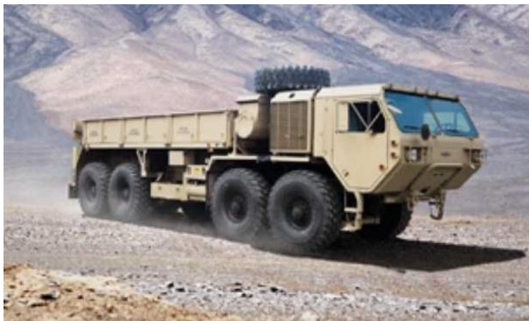
รูปที่ 3 ตัวอย่างยานพาหนะทางทหาร Oshkosh HEMTT ที่ใช้ Supercapacitor เป็นแหล่งพลังงาน (ที่มาของรูป : Oshkosh Defense)
