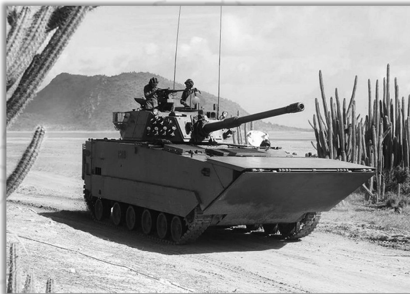
ตัวอย่างรูปภาพ รถเกราะสายพานสะเทินน้ำสะเทินบก VN-16 (Chinese MoD)
