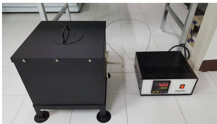
ภาพที่ 4-2 ตัวเตา (thermal chamber) และเครื่องควบคุมการให้ความร้อน (heating controller)
